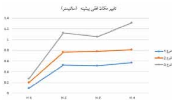
شکل ۸- نمودار بیشینه تغییر شکل افقی دیوار - زاویه ۱۵ درجه و ارتفاع ۹ متر
